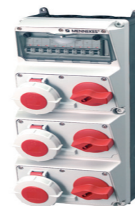
940027 Caja combinada con 3 tomacorrientes 32A 3P+T 440V 3H con 3 int.termo 3x32A IP67
