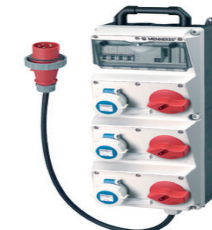
940030 Caja combinada 3 tomacorrientes 16A 2P+ T 250V 6H con 3 int.termo 2x16A + int.difer 4X40A. Grado de protección: IP67
