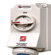
7012A Tomacorriente visible 16A 2P+T 250V 6H con interruptor de enclavamiento mecánico DUO. Grado de protección: IP67
